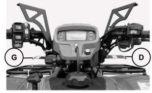
Étape 3 : Avec l'aide d'une autre personne, positionner la base du déflecteur en le centrant au phare du VTT, ensuite, installer les vis pour le maintenir aux supports, ajuster les plaques supérieures à la même hauteur et au même degrés d'ouverture l'une de l'autre. Finalement serrer toute la quincaillerie.
