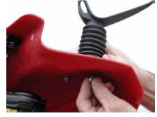
**NOTE:** Vous pouvez percer un trou de ½''(6.5 mm) diamètre à l'endroit indiqué sur le devant du déflecteur (voir la marque au bas de l'ouverture), ce qui vous donnera accès à la vis d'ajustement du phare.
