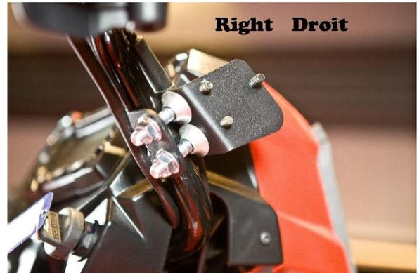
**Étape 3 :** Insérer les 4 boulons en acier inoxydable #54-LNV-78 aux trous de miroirs gauche et droit. Tourner ensuite le socle du miroir de 180° (Voir guide d'installation des miroirs).
