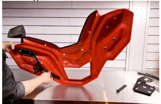
**Étape 5 :** Installer la visière à la base en utilisant les 6 boulons 54-VIPA-1 et les rondelles de caoutchouc ainsi que **Les 6 écrous 54-VIPA-2**
